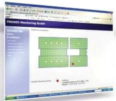
Visualisierung des Dichtheitszustandes der Abdichtung im Internet.
