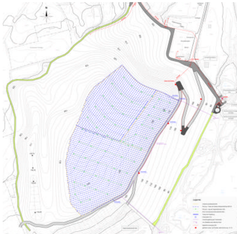
Abbildung 7: Lageplan des Dichtungskontrollsystems GEOLLOGGER
