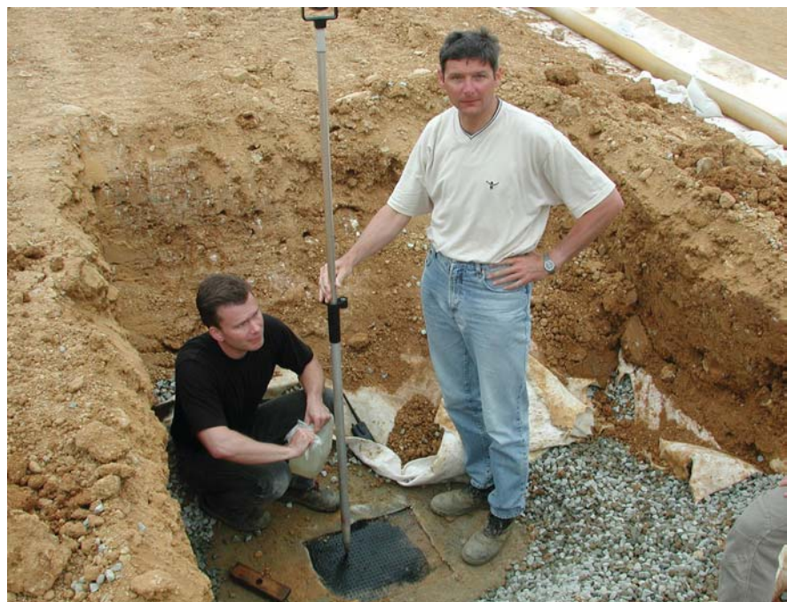
Der Fremdüberwacher prüft tachymetrisch die Genauigkeit der georteten Testleckagen.
